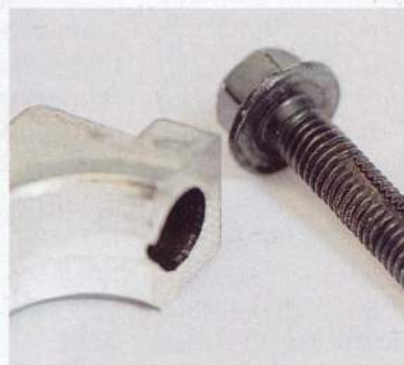
Besser nicht verwechseln: Jeweils einer von zwei Haltebolzen der Nockenwellenlagerböcke besitzt eine Nut, durch die das Lager mit Öl versorgt wird
