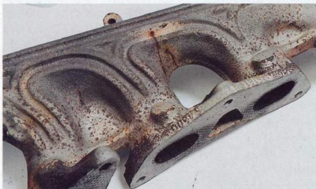
Überfordert: Bei frühen Modellen bis 1985 mit aufgeladenen Motoren kommt es häufig zu Rissen im Abgaskrümmen
